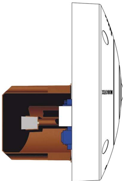
Fig. 6: Vista laterale di MOBOTIX c71 con presa a muro a incasso
