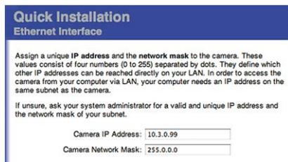
Fig. 21: Impostazioni di rete nell'interfaccia Web della telecamera.
