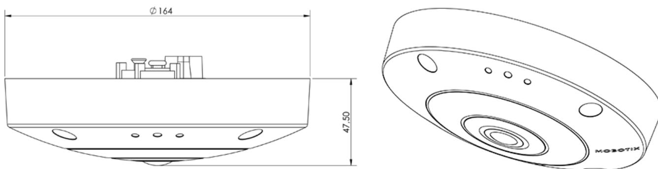
Fig. 5: MOBOTIX c71: Tutte le misurazioni in mm
