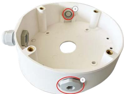
4. Montare il pressacavo ③ sull'apertura del cavo di On-Wall Set in modo che la guarnizione in gomma nera si trovi all'esterno. Fissarlo in posizione dall'interno con un piccolo dado esagonale.
