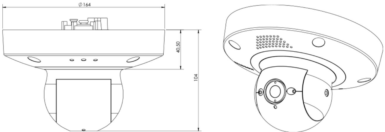
Fig. 5: MOBOTIX p71 ECO Thermal: Todas las medidas en mm
