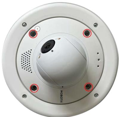
5. Collegare il cavo di rete sul posto per il collegamento con il cavo patch della videocamera utilizzando un connettore standard. Il cavo in eccesso può essere riposto facilmente all'interno di In-Ceiling Set (vedere [Collegamento della videocamera, p. 46](#)).
