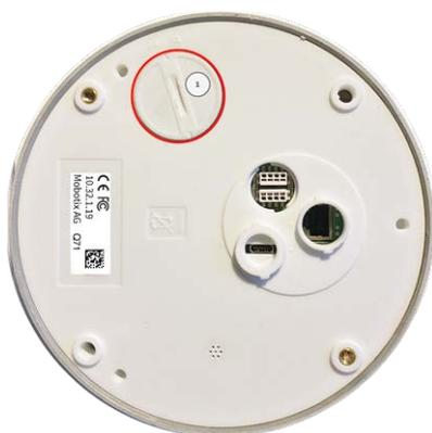
3. **Sbloccare il supporto della scheda microSD:** sollevare il coperchio metallico ② della scheda microSD (ad esempio, con un'unghia).
