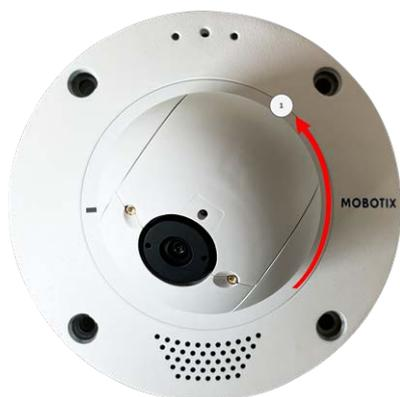
2. Allentare le quattro viti di fissaggio dall'anello di bloccaggio con la chiave a brugola [Materiali di montaggio: Contenuto della confezione, p. 19](#).
