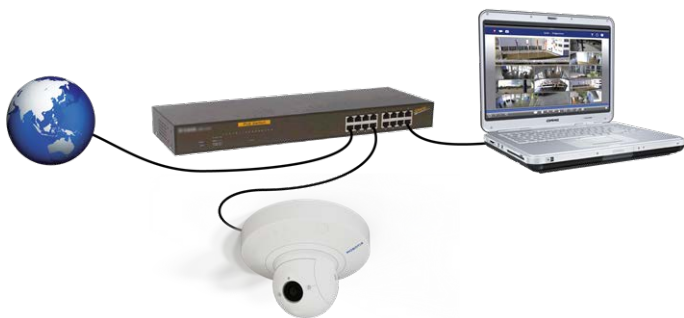
Abb. 17: Stromversorgung über PoE-Switch gemäß PoE Plus (802.3at-2009).
