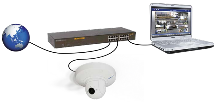
Fig. 17: Fuente de alimentación mediante un conmutador PoE según la PoE Plus (802.3at-2009)
