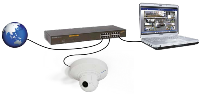
Fig. 17: Alimentazione tramite interruttore PoE in base allo standard PoE Plus (802.3at-2009).
