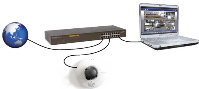
Abb. 17: Stromversorgung über PoE-Switch gemäß PoE Plus (802.3at-2009).
