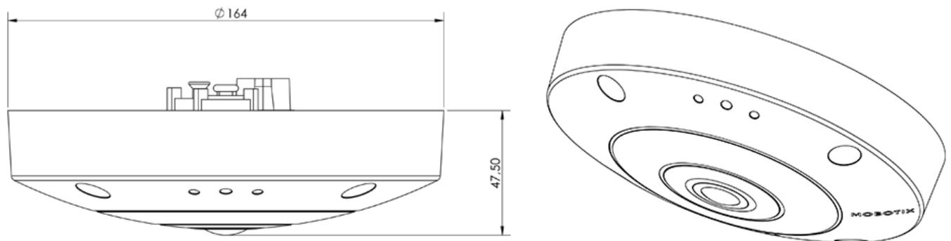
Abb. 1: MOBOTIX Q71: Alle Maßangaben in mm
