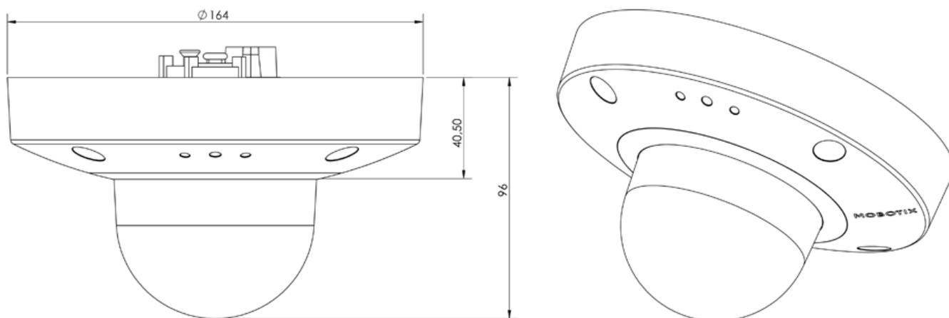
Fig. 1: MOBOTIX v71: Todas las medidas en mm
