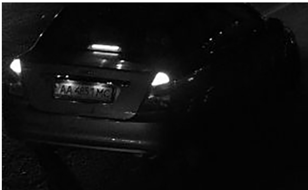
Fig. 16: Luce insufficiente per il riconoscimento della targa
