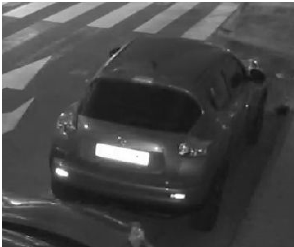
Fig. 15: Plaques d'immatriculation surexposées à cause d'une LED IR trop forte
