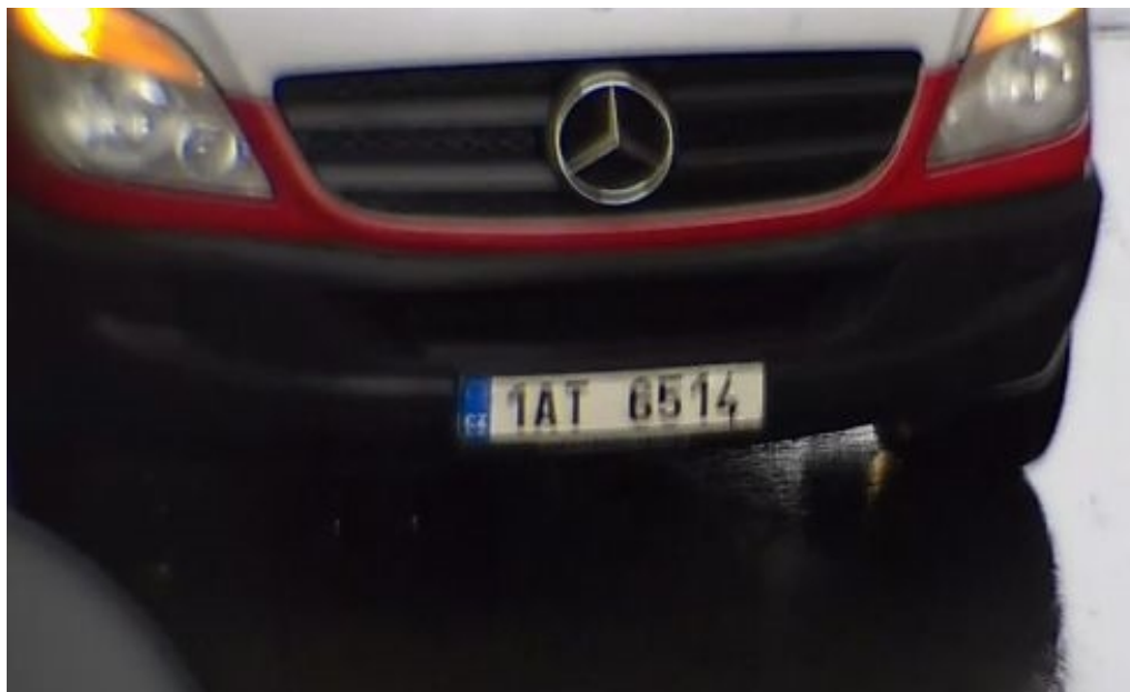
Fig. 13: Plaque d'immatriculation floue à cause d'une longue durée d'exposition
