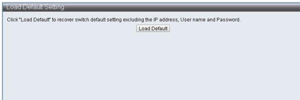
**AVISO!** La función Cargar valor predeterminado de fábrica solo puede devolver este conmutador PoE a la configuración predeterminada. El valor de Nombre de usuario, Contraseña y Dirección IP seguirá siendo el mismo.
