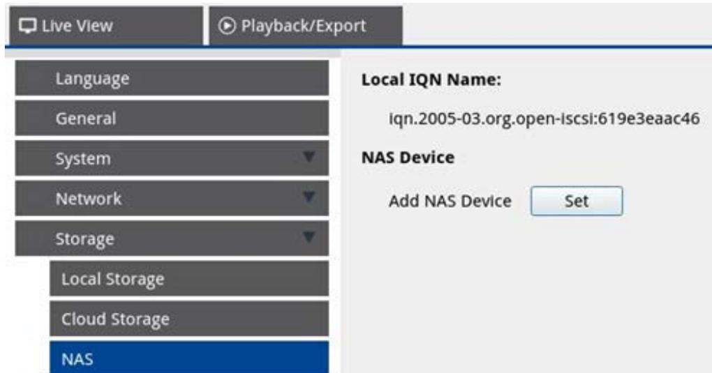
1. Fare clic su **Set (Imposta)** per aggiungere il dispositivo NAS una volta eseguita la connessione al sistema NVR.
