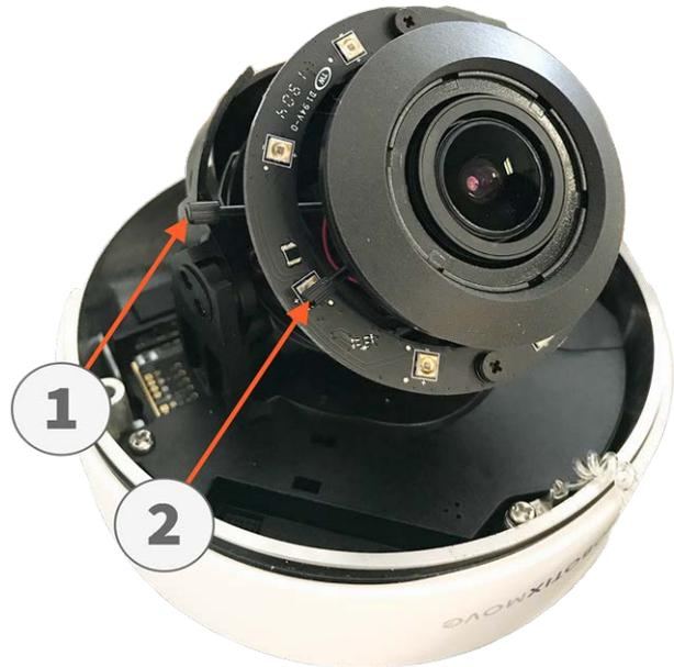
**AVISO!** Tenga cuidado de apretar correctamente la palanca de distancia focal ① , la palanca de enfoque ② y los tornillos del cardán de 3 ejes para evitar cambios no deseados debido a las vibraciones, por ejemplo.
