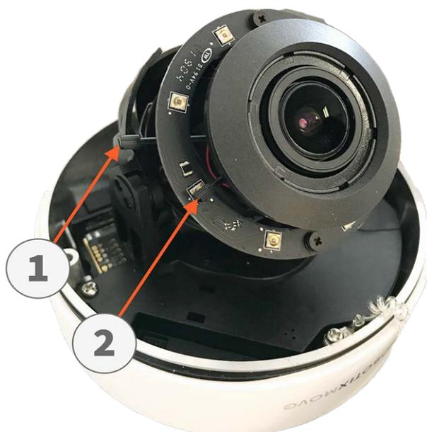
**AVIS!** Veillez à bien serrer le levier de distance focale ① , le levier de mise au point ② et les vis du cadran à 3 axes afin d'éviter les changements indésirables dus aux vibrations, par exemple.
