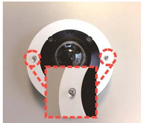
2. Coloque la cámara en el lugar de instalación. Marque la posición de los dos orificios para tornillos indicados en la figura de la derecha en el techo o la pared. A continuación, dibuje una línea a lo largo del borde cóncavo de la cámara para indicar la posición del cable.
