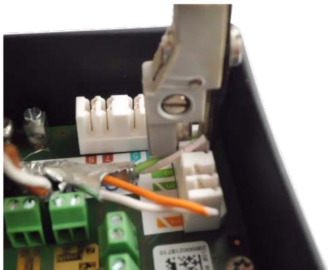
Abb. 33: Mit Krone LSA-Plus-Anlegewerkzeug angeschlossenes Netzkabel
