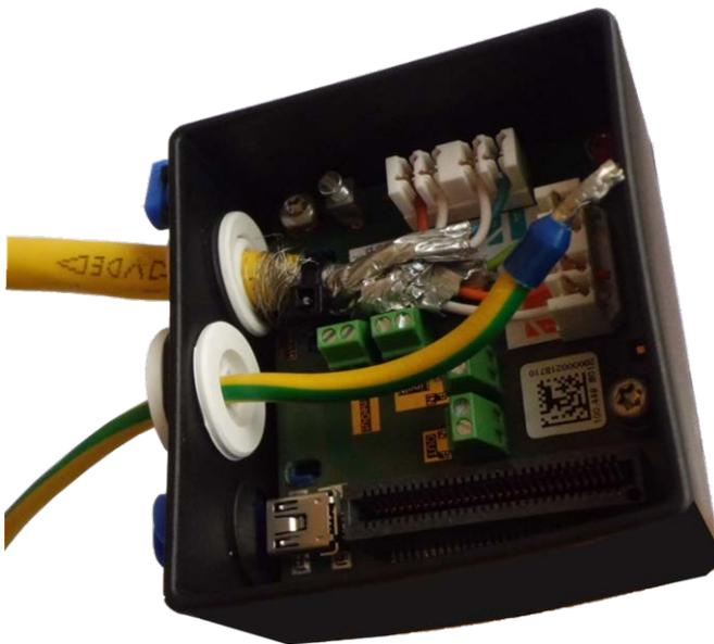
Abb. 35: Masseleitung eingesteckt, Stopfen richtig eingesetzt
