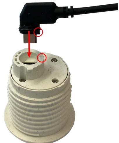
5. **Verriegeln Sie das Kabel des Sensormoduls:** Bringen Sie den blauen Bajonettverschluss wie dargestellt am Anschluss des Sensormoduls an und drehen Sie ihn im Uhrzeigersinn, bis er leicht einrastet.
