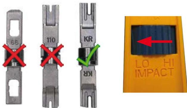
Abb. 32: Krone LSA-Plus-Anlegewerkzeug auf GERINGE Kraft eingestellt
