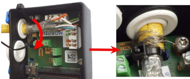
Abb. 31: Kabelbinder unter Netzkabel eingeführt
