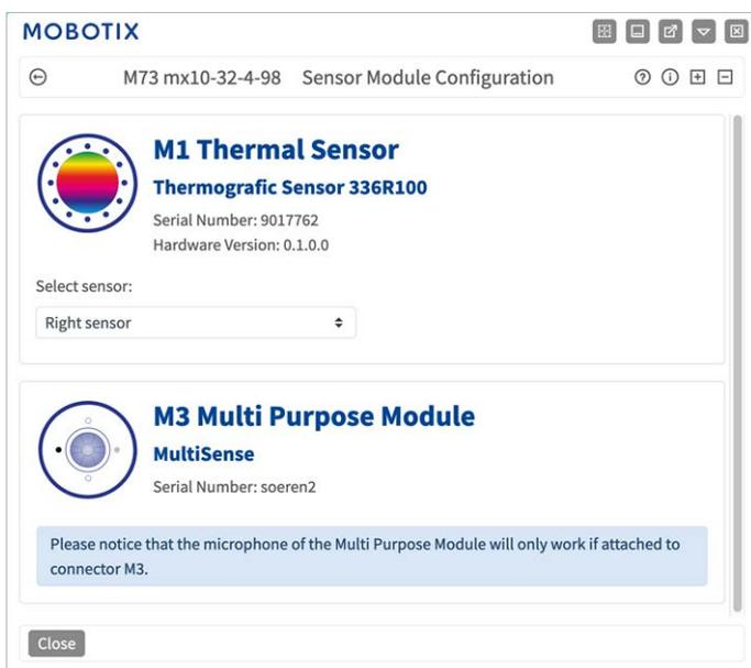
Die Verwendung verschiedener Kombinationen von Sensormodulen der MOBOTIX M73 hat Einfluss auf die verfügbaren Anzeigemodi und Konfigurationsvarianten.
