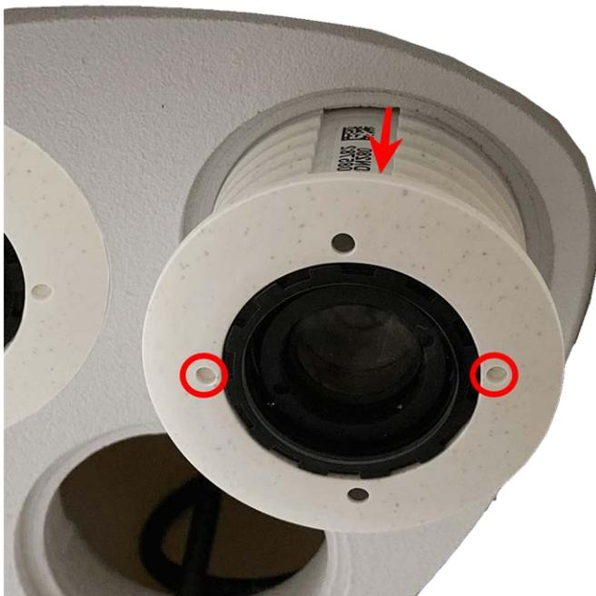
Abb. 17: Sensormodul aus Modulgehäuse entfernen
