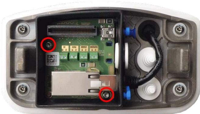
**VORSICHT!** Stellen Sie sicher, dass die Anschlussbox wie oben dargestellt ordnungsgemäß auf der Montageplatte befestigt ist. Andernfalls kann die Hauptplatine der Kamera beschädigt werden!
