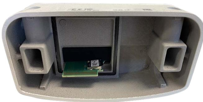
Abb. 43: Öffnen des Kameragehäuses
