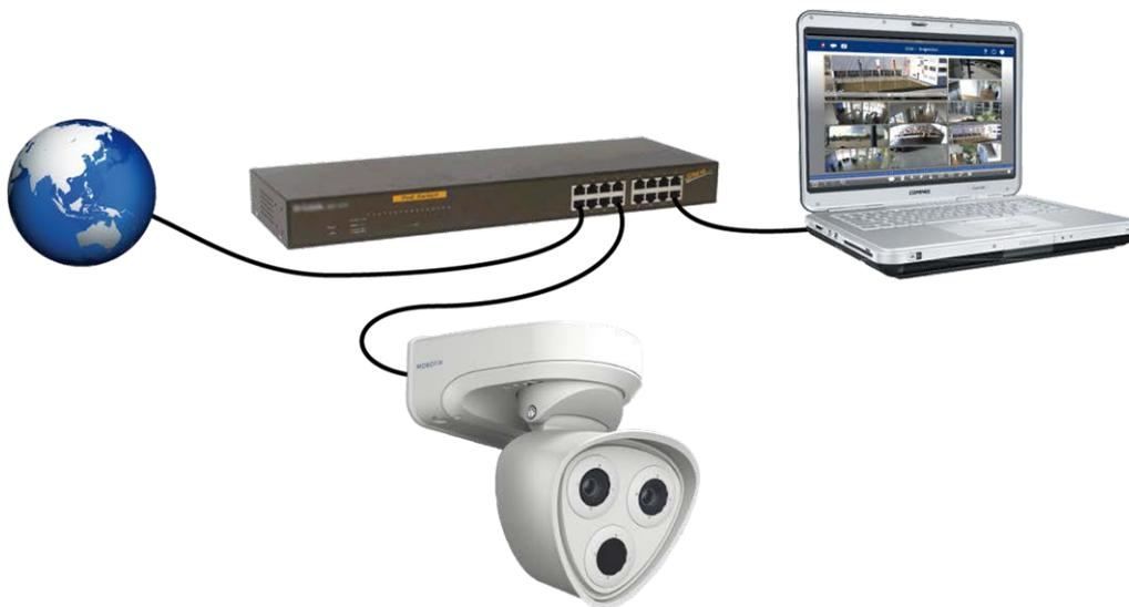
Abb. 25: Stromversorgung über PoE-Switch gemäß PoE Plus (802.3at-2009).
