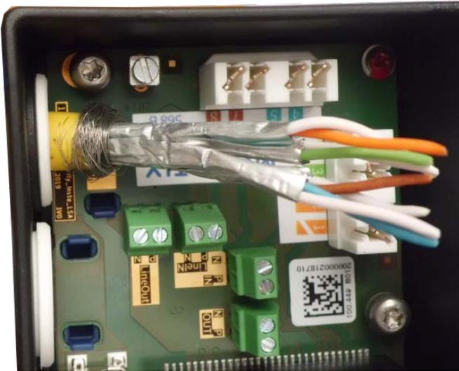
Abb. 30: Netzkabel eingesteckt, Stopfen richtig eingesetzt
