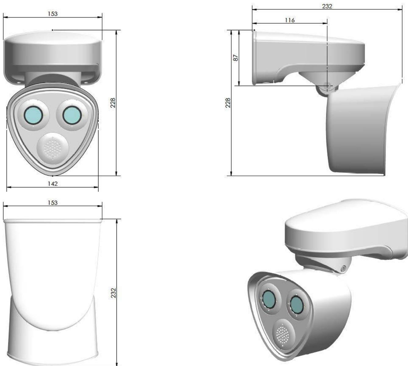
Abb. 4: MOBOTIX M73: Alle Maßangaben in mm
