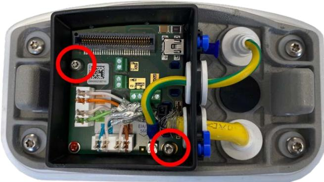
Abb. 37: Connector Box LSA (Draufsicht) mit zwei Schrauben (rot hervorgehoben) an Montageplatte montieren
