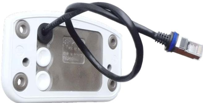
2. Das mitgelieferte Netzkabel [1.7](#) hat eine integrierte Gummidichtung. Schieben Sie das Netzkabel durch die obere Öffnung der Montageplatte, sodass der Trichter des Gummistopfens ① zur Kamera zeigt.
