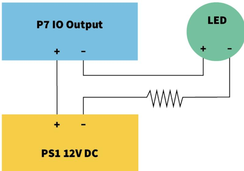
Der Wert des Pull-up-Widerstands hängt von der Durchlassspannung der LED bei dem spezifischen Strom ab, den Sie durchleiten möchten.
