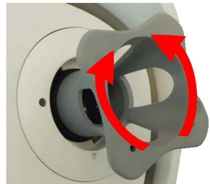
**VORSICHT!** Wenden Sie beim Drehen des Objektivs niemals Gewalt an und schrauben Sie das Objektiv niemals zu tief in das Gewinde ein, da dies den Bildsensor beschädigen könnte! Drehen Sie das Objektiv im Zweifelsfall gegen den Uhrzeigersinn und drehen Sie es dann im Uhrzeigersinn, um es zu fokussieren.
