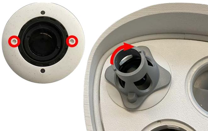
Fig. 12: Bloquee el módulo de sensor
