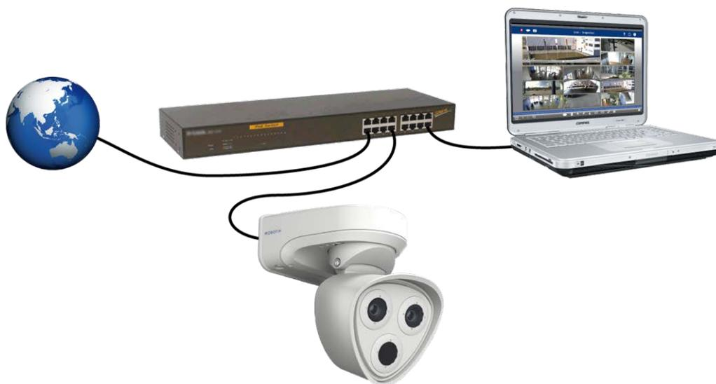
Fig. 25: Fuente de alimentación mediante un conmutador PoE según la PoE Plus (802.3at-2009)
