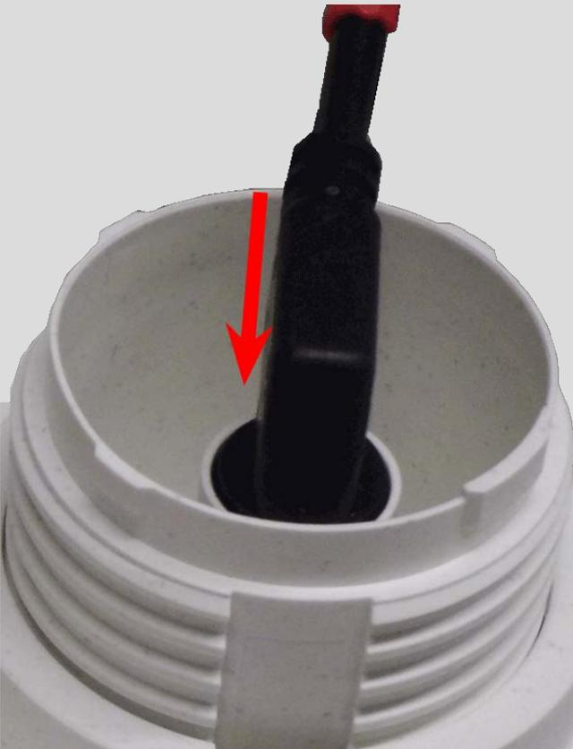
5. **Bloquee el cable del módulo del sensor:** Coloque el cierre de bayoneta azul en el conector del módulo del sensor tal como se muestra y gírelo hacia la derecha hasta que encaje suavemente.
