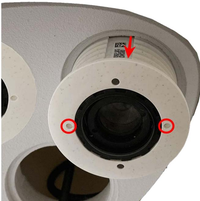
Fig. 17: Extracción del módulo de sensor desde la carcasa del módulo
