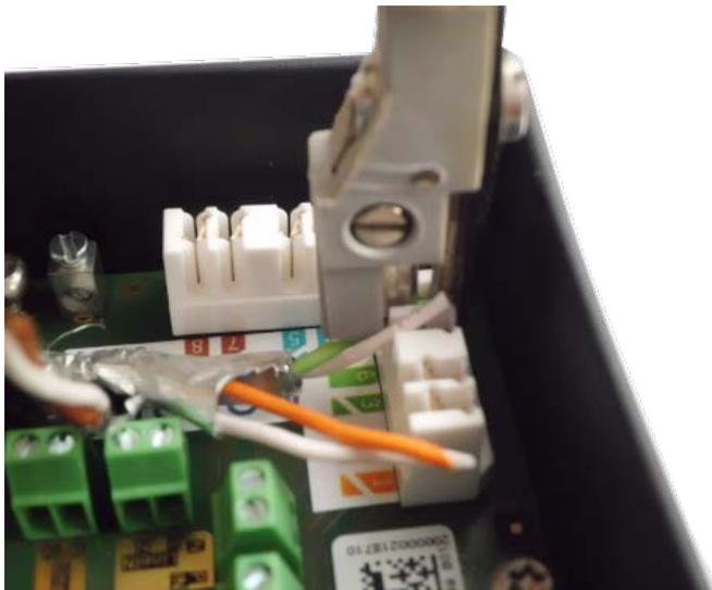
Fig. 33: Cables de red conectados mediante la herramienta LSA+/Krone
