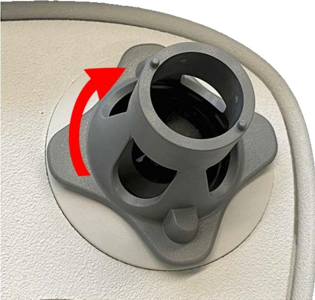
**ATENCIÓN!** Si no puede girar el módulo de sensor es debido a que no se ha insertado correctamente. Retire el módulo de sensor, gírelo 180 grados y vuelva a insertarlo.
