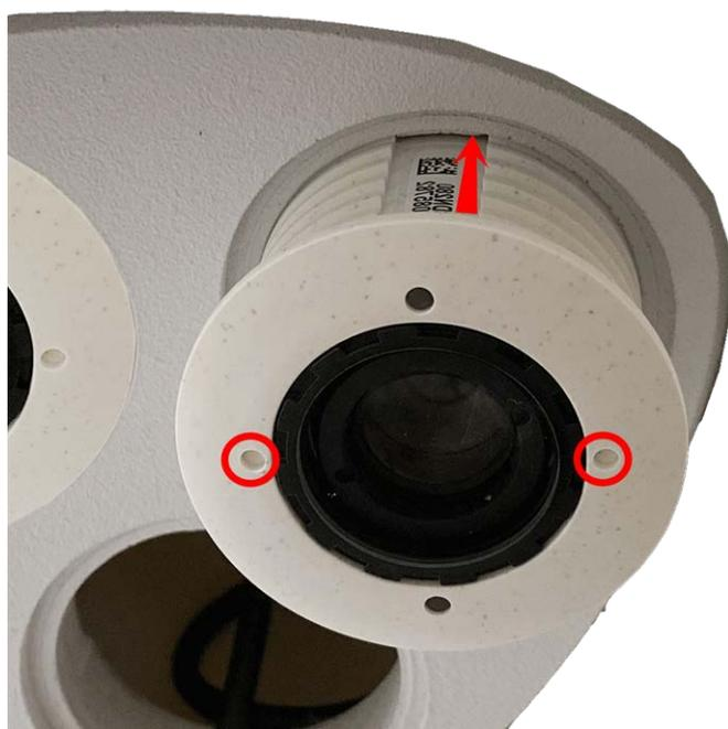
3. **Bloquee el módulo de sensor:** Con la llave del módulo gris [M.1](#), gire el módulo de sensor hacia la derecha hasta que se detenga.
