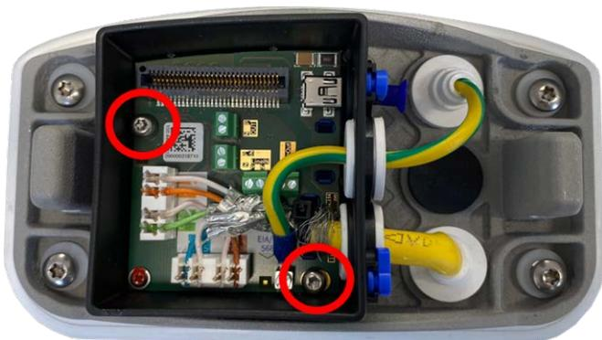
Fig. 37: Monte el Connector Box LSA (imagen superior) con los dos tornillos (resaltados en rojo) en la placa de montaje
