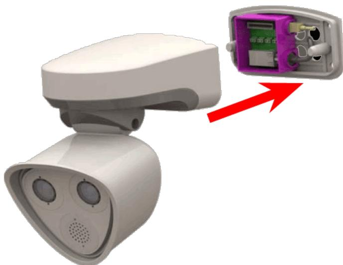
1. Presione el cuerpo de la cámara sobre la placa de montaje instalada, de modo que la junta de la pared selle bien el cuerpo de la cámara.
