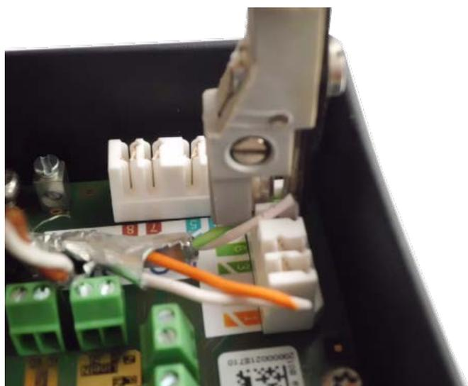
Fig. 33: Fils réseau connectés à l'aide de l'outil LSA+/Krone
