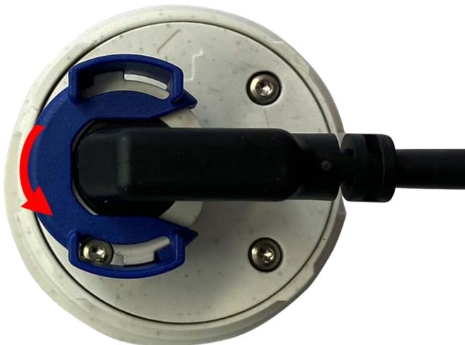
Fig. 14: Déverrouillez le câble du module de capteur
