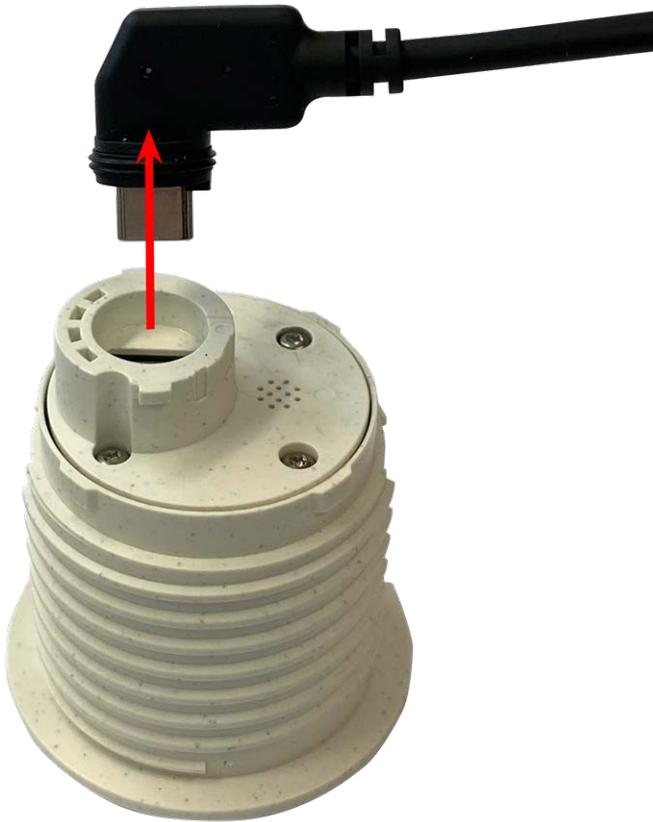
Fig. 15: Retirez le câble du module de capteur
