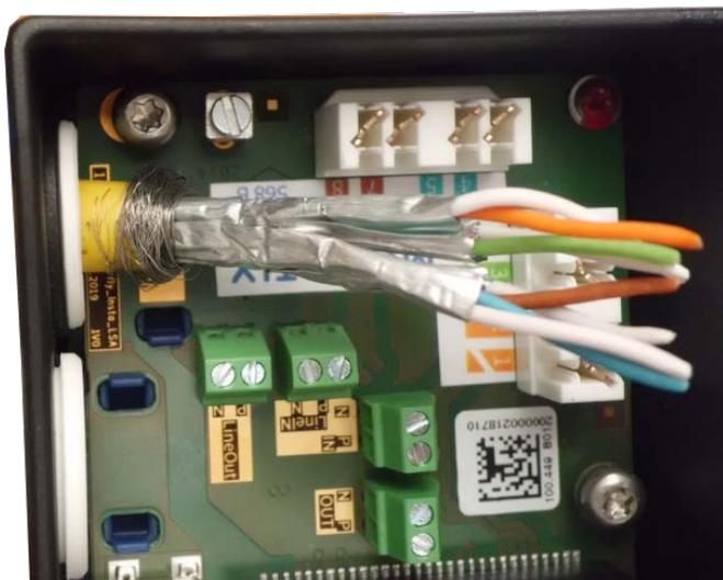
Fig. 30: Câble réseau inséré, bouchon correctement installé
