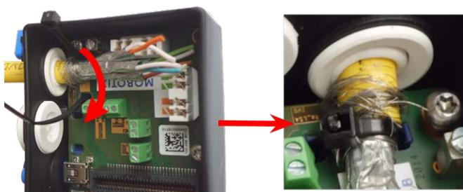
Fig. 31: Serre-câble inséré sous le câble réseau
