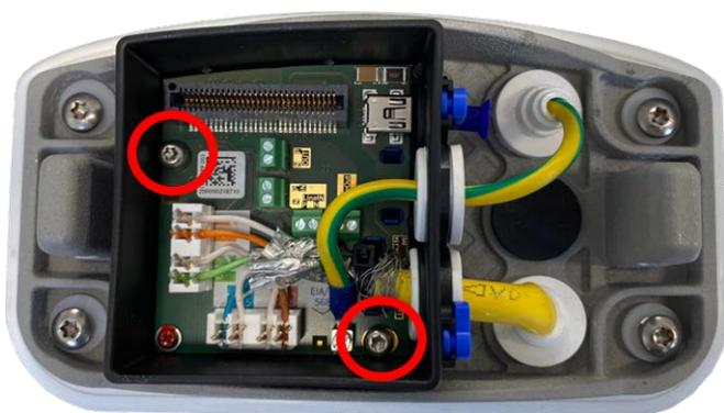
Fig. 37: Montez le Connector Box LSA (vue de dessus) à l'aide des deux vis (surlignées en rouge sur la figure) sur la plaque de montage
