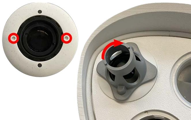
Fig. 12: Bloquez le module de capteur
