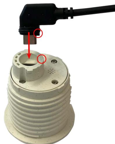
5. **Bloccare il cavo del modulo sensore:** Applicare il fermo a baionetta blu sul connettore del modulo sensore come mostrato e ruotarlo in senso orario fino a quando non scatta delicatamente in posizione di chiusura.
