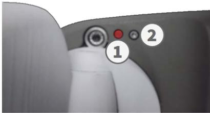
**AVISSO!** Premendo il tasto della telecamera, la telecamera comunica l'indirizzo IP corrente tramite l'altoparlante (se collegato).
