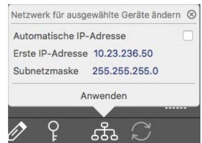
**AVISSO!** Gli indirizzi IP delle altre telecamere vengono incrementati automaticamente di 1.
