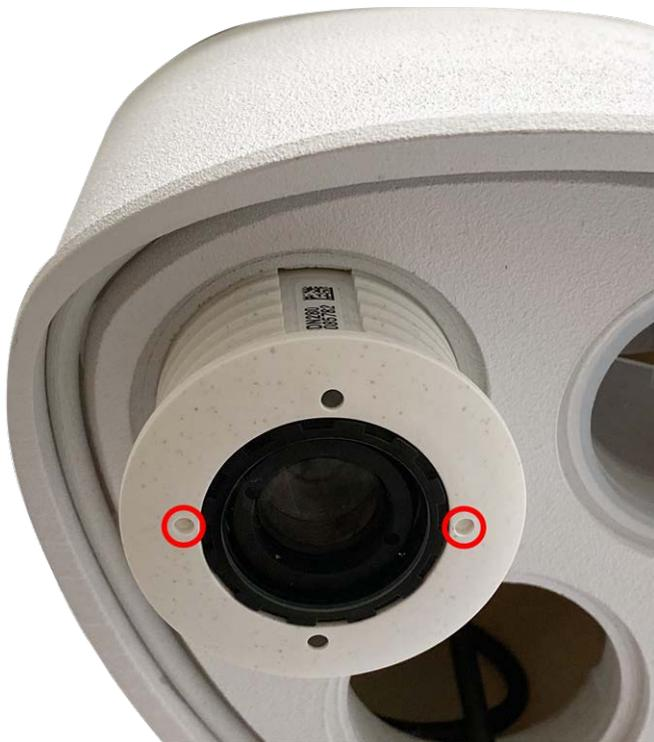
Fig. 16: Sbloccare il modulo sensore
