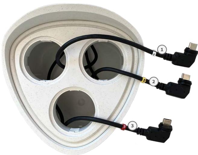
Fig. 8: Cavi del modulo sensore numerati
