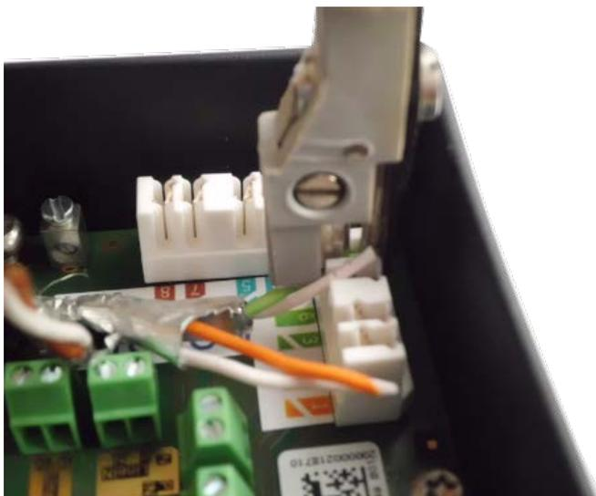
Fig. 33: Fili del cavo di rete collegati mediante lo strumento LSA+/Krone
