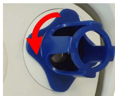
**ATTENZIONE!** Se i fermi di sicurezza rossi M.14 non sono stati installati, anche il modulo sensore ruoterà! In tal caso, continuare a girare finché il modulo sensore non si arresta nella posizione per la rimozione.
