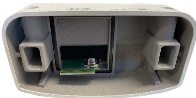
Fig. 43: Aprire il corpo della telecamera
