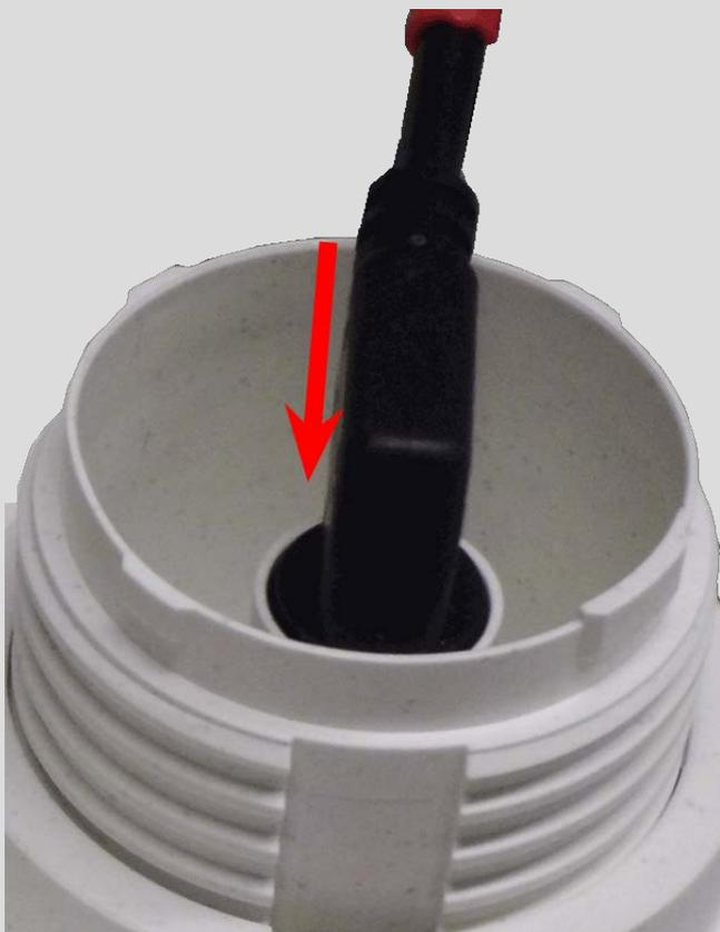
5. **Bloccare il cavo del modulo sensore:** Applicare il fermo a baionetta blu sul connettore del modulo sensore come mostrato e ruotarlo in senso orario fino a quando non scatta delicatamente in posizione di chiusura.
