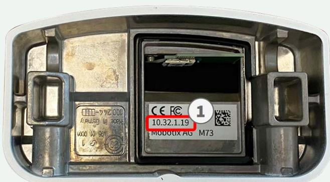
Fig. 5: Indirizzo IP sul retro dell'alloggiamento della telecamera
