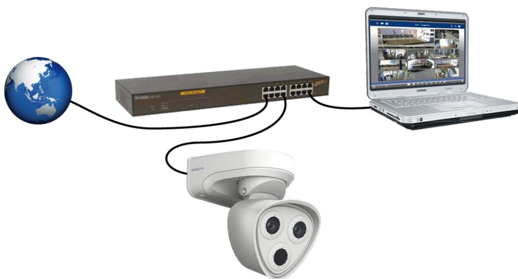
Fig. 25: Alimentazione tramite interruttore PoE in base allo standard PoE Plus (802.3at-2009).
