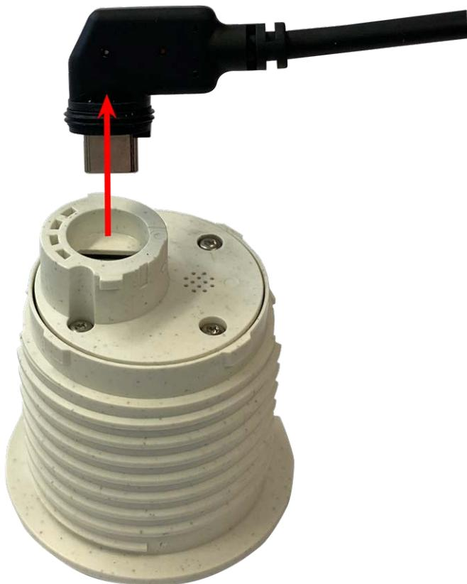
Fig. 15: Rimuovere il cavo del modulo sensore
