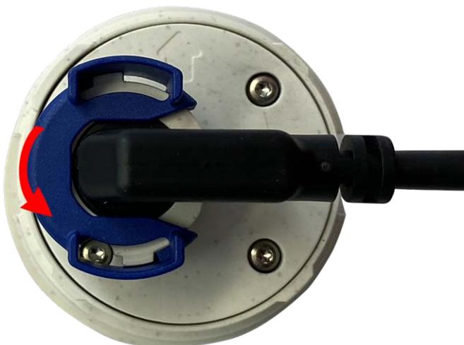
Fig. 14: Sbloccare il cavo del modulo sensore
