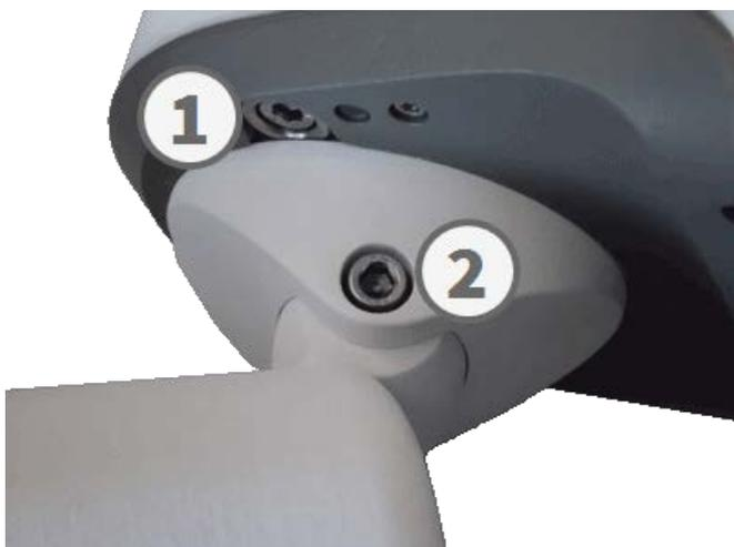
6. Premere i due coperchi [M.15](#) sulle due viti a brugola (② , figura superiore) del perno centrale.
