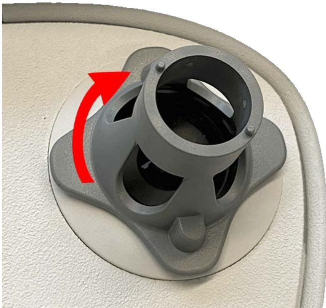
**ATTENZIONE!** Se non è possibile ruotare il modulo sensore, è stato inserito in modo errato! Rimuovere il modulo sensore, ruotarlo di 180 gradi e inserirlo nuovamente.
