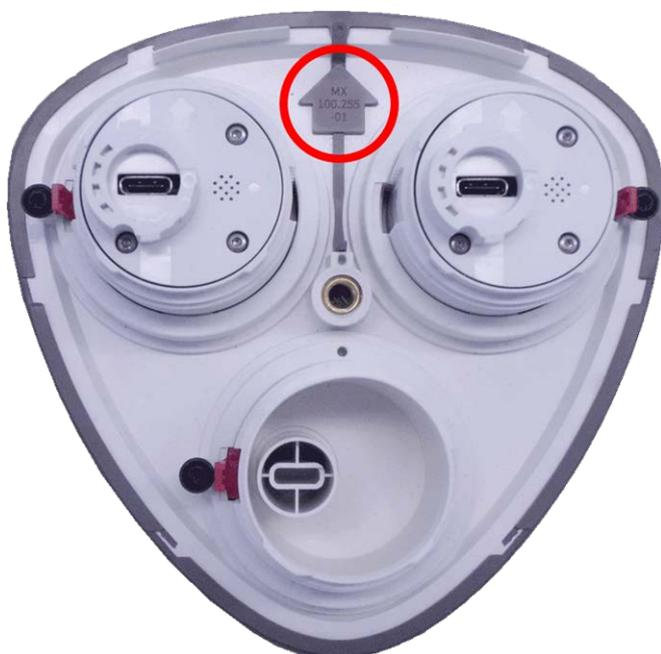
2. Spingere la piastra anteriore nell'alloggiamento del modulo fino a quando non si arresta.
