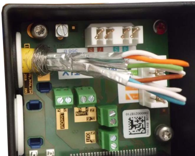
**Fig. 30: Cavo di rete inserito, tappo posizionato correttamente**
