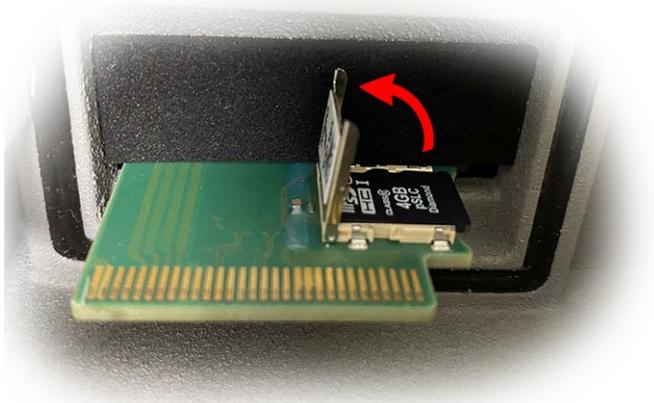
Fig. 44: Sbloccare il supporto della scheda microSD
