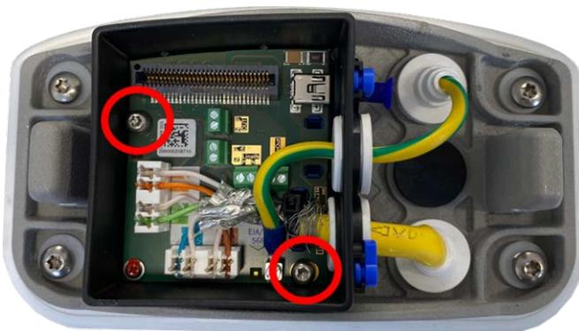
Fig. 37: Montare la Connector Box LSA (vista dall'alto) utilizzando le due viti (evidenziate in rosso nella figura) sulla piastra di montaggio
