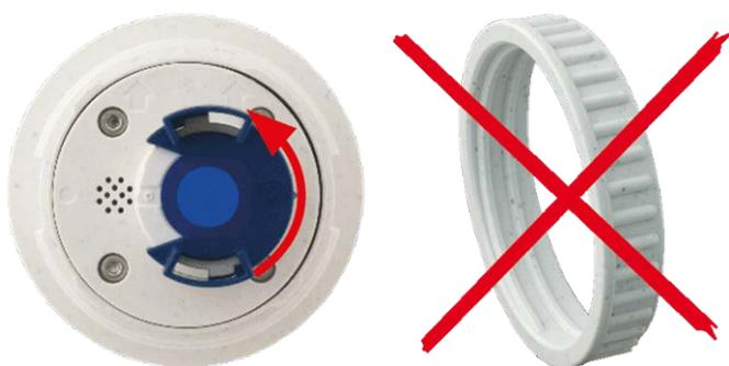
2. **Inserire i moduli sensore/funzionali nella piastra anteriore Thermal:** Spingere il modulo sensore nella relativa presa. La freccia sul retro del modulo è rivolta verso le ore 9 quando si guarda il modulo come mostrato nella figura.
