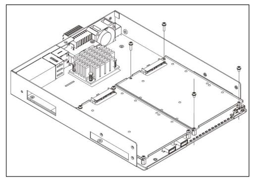
3. Sujete el HDD con los tornillos de fijación suministrados, según se muestra a continuación.
