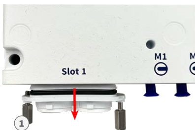
Abb. 18: Entfernen der Abdeckung vom Steckplatz der Schnittstellenkarte
