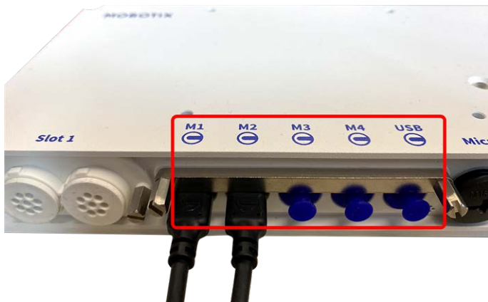
Abb. 22: 4 Modulsteckeranschlüsse und 1 USB-C-Schnittstelle
