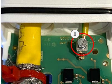
Fig. 15: Fil de terre connecté à la borne
