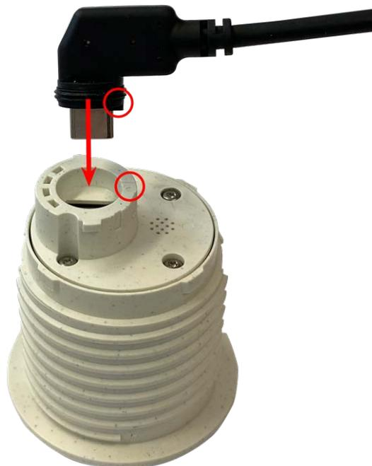
**ATTENZIONE!** Il capocorda della spina deve essere rivolto verso l'interno del modulo sensore quando è collegato. Se il cavo del modulo non è collegato correttamente, il sensore non verrà riconosciuto dalla videocamera.
