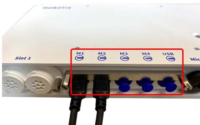
Fig. 22: 4 porte per connettore modulo e 1 interfaccia USB-C
