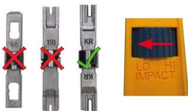
Fig. 12: Strumento LSA+/Krone impostato su impatto LOW (basso)
