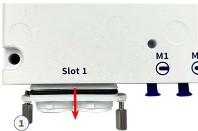
Fig. 18: Rimuovere il coperchio dallo slot della scheda di interfaccia
