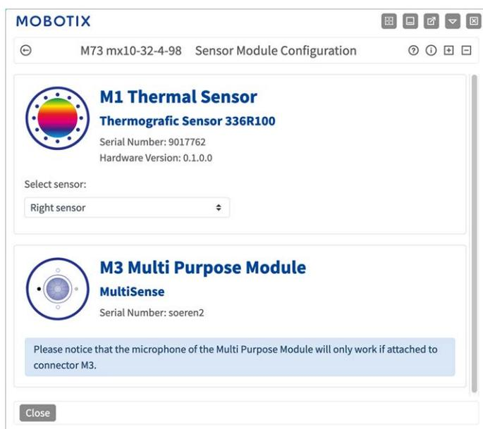
L'uso di diverse combinazioni di moduli sensore di MOBOTIX S74 influisce sulle modalità di visualizzazione e sulle varianti di configurazione disponibili.
