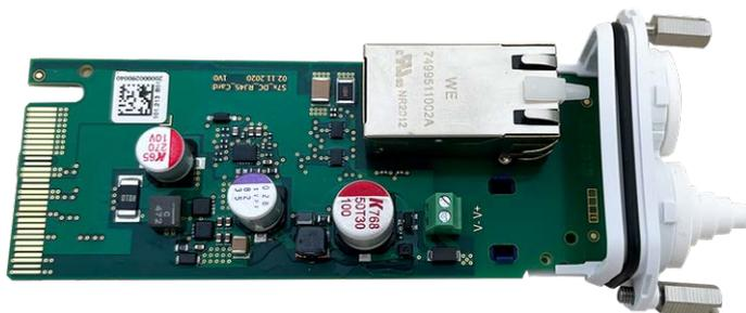
**ATTENZIONE!** La S74 Network Slide in Board with RJ45 and VDC power supply può essere installata solo nello slot 2 della telecamera.
