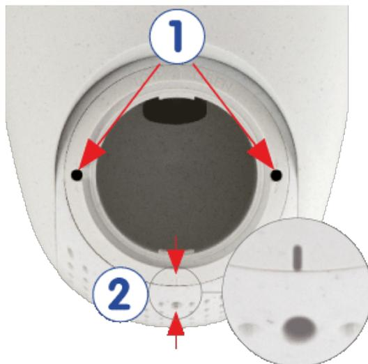
13. Bloccare l'inserto in modo che non ruoti serrando le due viti di fissaggio con una chiave a brugola da 2,5 mm.
