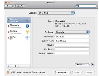
2. Fare clic su **Ethernet** e nel campo **Configurazione**, selezionare la voce *Manuale* e immettere un indirizzo IP nell'intervallo di indirizzi IP 10.x.x.x (ad esempio, 10.16.0.11).
