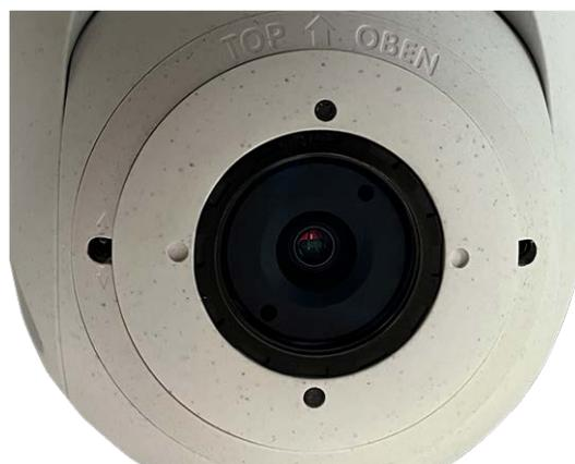
16. Utilizzando la chiave per moduli, bloccare il modulo sensore ruotandolo di 90 gradi verso destra.
