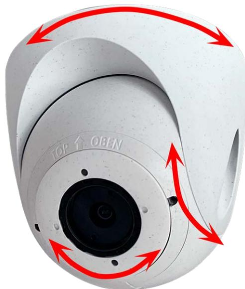
19. Assicurarsi che l'etichetta **TOP/OBEN** sull'inserto sia rivolta verso l'alto. In caso contrario, allentare le due viti di fissaggio utilizzando la chiave a brugola da 2,5 mm e ruotare l'inserto.
