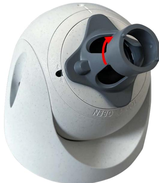
17. Fissare il modulo sensore serrando la vite di riferimento con una chiave a brugola da 2,5 mm. La vite filettata blocca il modulo sensore all'interno dell'inserto e impedisce che il modulo sensore si sblocchi accidentalmente.
