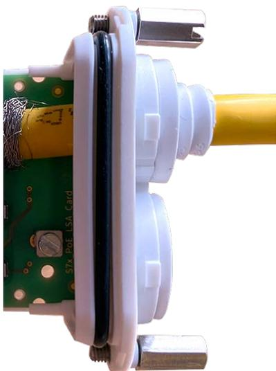
Fig. 10: Cavo di rete inserito, tappo posizionato correttamente
