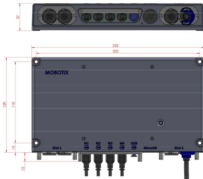
Fig. 1: MOBOTIX S74: Tutte le misurazioni in mm
