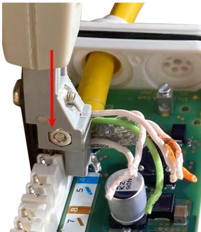
Fig. 13: Fili del cavo di rete collegati mediante lo strumento LSA+/Krone
