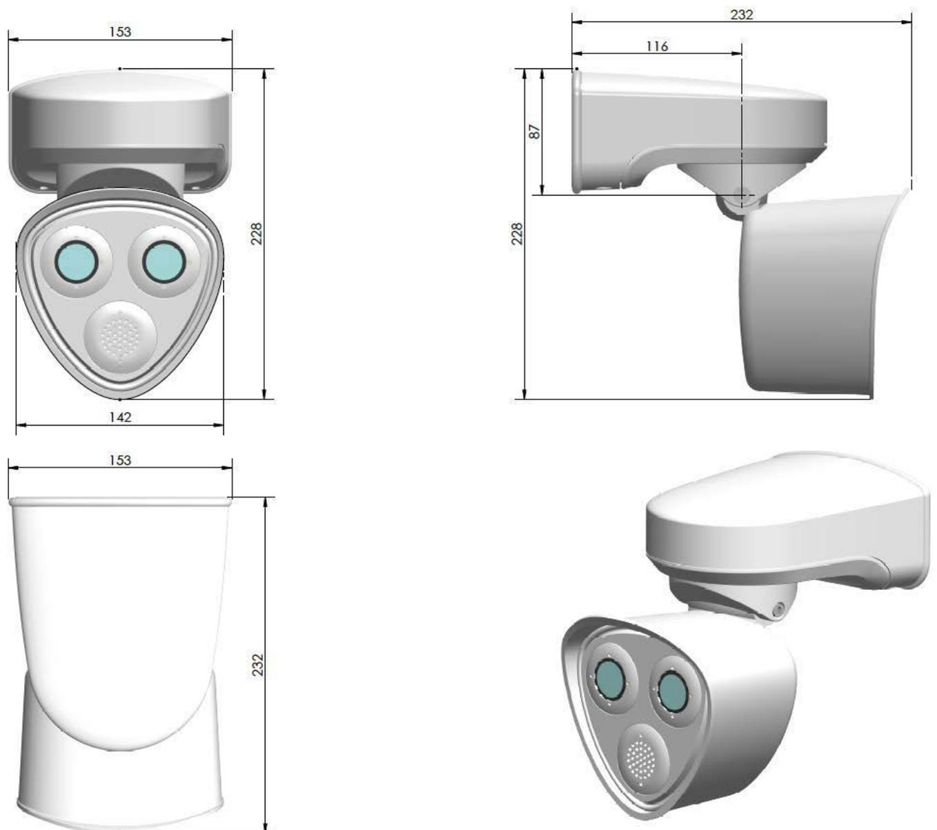
Abb. 1: MOBOTIX M73: Alle Maßangaben in mm
