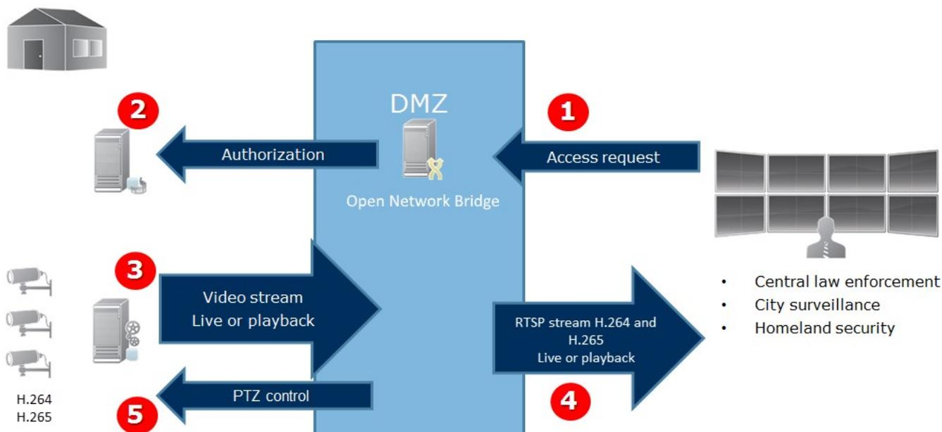
1. Un client ONVIF se connecte au MOBOTIX HUB VMS via le serveur MOBOTIX Open Network Bridge sur Internet. Pour cela, le client ONVIF doit avoir l'adresse IP ou le nom de domaine (domaine/nom d'hôte) du serveur où est installé le MOBOTIX Open Network Bridge et le numéro de port ONVIF.
