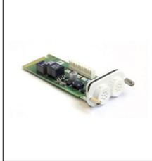
**Mx-F-S7A-LSA****S74 Netzwerk Einschubplatine mit LSA-Anschlussklemme**
