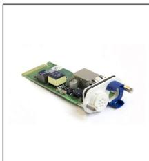
**Mx-F-S7A-RJ45****S74 Netzwerk Einschubplatine mit RJ45-Buchse**
