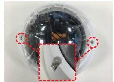
2. Ouvrez le bloc d'entrée du conduit arrière à l'aide d'une pièce de monnaie et placez-le sur l'entrée du conduit latéral.
