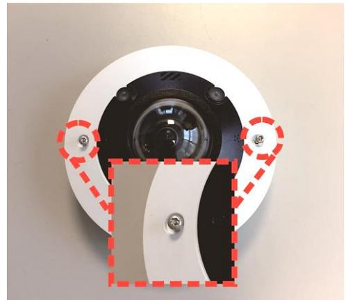
2. Collocare la telecamera nella posizione di installazione. Contrassegnare la posizione dei due fori delle viti indicata nella figura a destra sul soffitto o sulla parete. Quindi tracciare una linea lungo il bordo concavo della telecamera per indicare la posizione del cavo.
