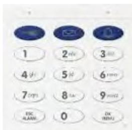
Das wetterfeste KeypadRFID-Modul ermöglicht die schlüssellose Türöffnung über RFID-Transponder und/oder eine Nummernkombination, das Klingeln an beliebig vielen Gegenstellen über programmierbare Tastenkombinationen sowie die Konfiguration der Türstation ohne PC. Mit Mailbox-Funktion und Transponder im Scheckkartenformat.
