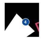
Wenn eine Unterscheidung der 40 mm breiten schwarzen und weißen Abschnittsspitzen im äußeren Kreis möglich ist, ist das **Qualitätsniveau** "Detektieren" erreicht.
