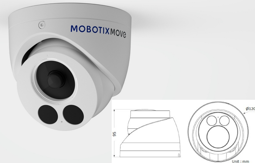
MOVE Turret 2-IR/5-IR mit festem Objektiv, 2MP oder 5MP Bildsensor Blickwinkel (2MP): H: 105°, V: 56°; Blickwinkel (5MP): H: 97°, V: 70.5°
