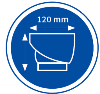
Kompaktes und kuppellooses Design (kein Reflexionen durch IR-Strahler)
