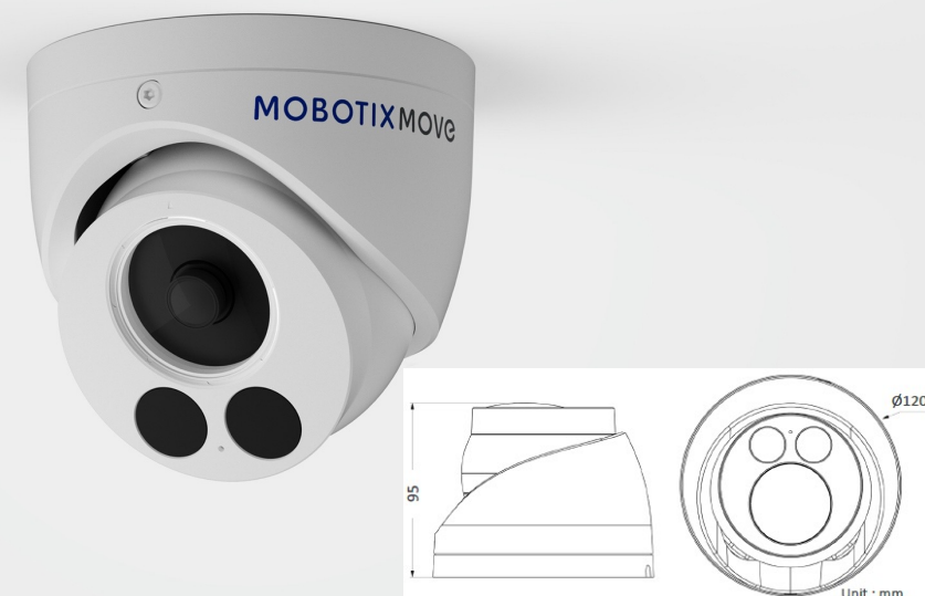
MOVE Torretta 2-IR/5-IR con obiettivo fisso , sensore di immagine da 2MP o 5MP Campo visivo (2MP): H: 105°, V: 56°; Campo visivo (5MP): H: 97°, V: 70,5°.
