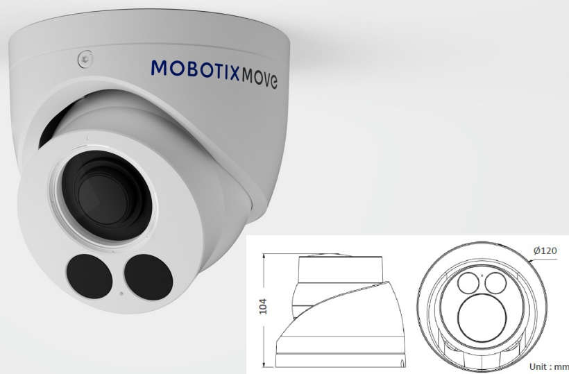
Torretta MOVE 203-IR/503-IR con obiettivo varifocale , sensore di immagine da 2MP o 5MP Campo visivo (2MP): H: 111°-33°, V: 61°-19°; campo visivo (5MP): H: 103°-31°, V: 76°-23°
