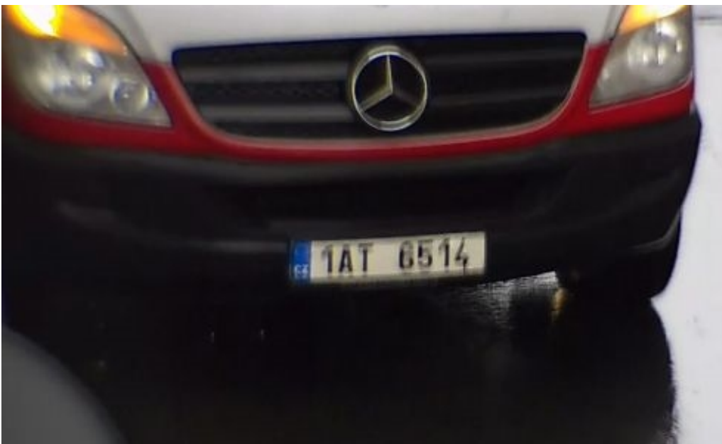
Abb. 15: Unscharfes Kennzeichen aufgrund langer Belichtungszeit
