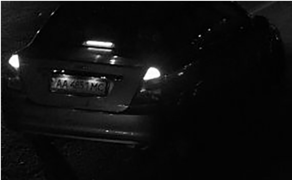
Abb. 18: Unzureichende Lichtverhältnisse zur Erkennung des Kennzeichens
