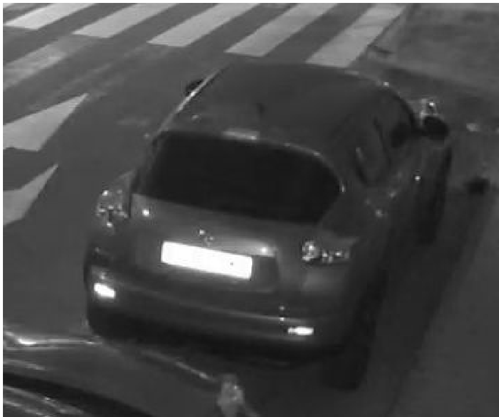
Fig. 17: Plaques d'immatriculation surexposées à cause d'une lumière LED IR trop forte
