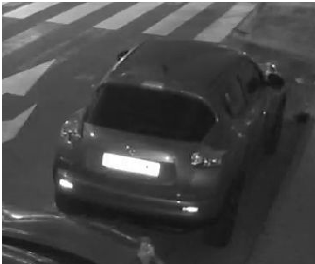
Fig. 17: Targhe sovraesposte a causa di una luce LED IR troppo forte
