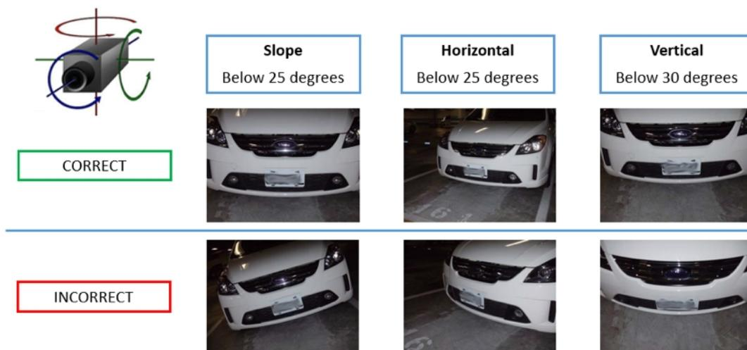
Fig. 11: Angolo di rotazione massimo
