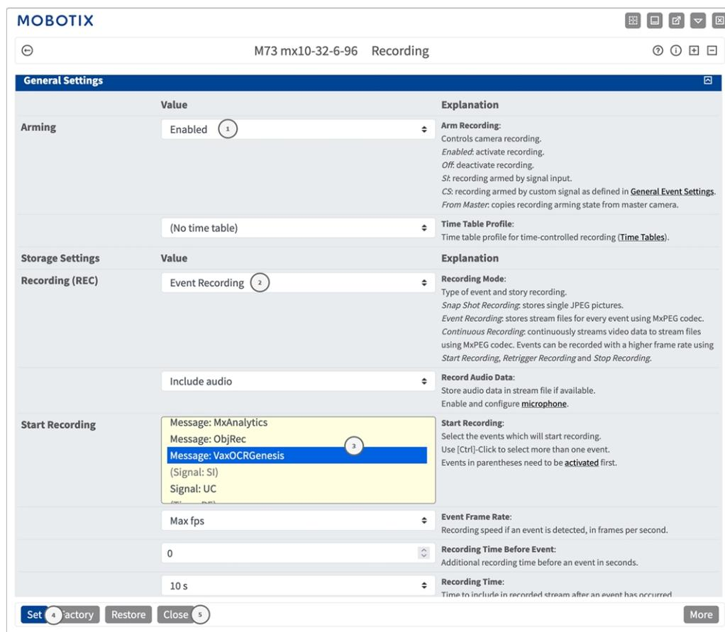
Fig. 25: Configuración de los ajustes de grabación de la cámara
