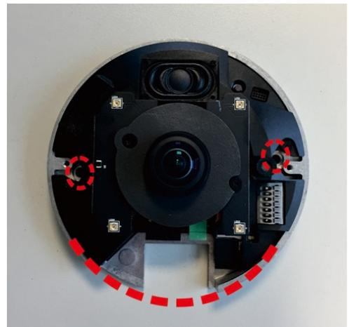
3. Zeichnen Sie an der Decke oder Wand einen Punkt 20 mm über der Mitte der markierten konkaven Kante. Legen Sie den markierten Punkt als Mittelpunkt fest, und ziehen Sie eine Kabeldurchführung mit einem Durchmesser von 30 mm (Radius 15 mm).
