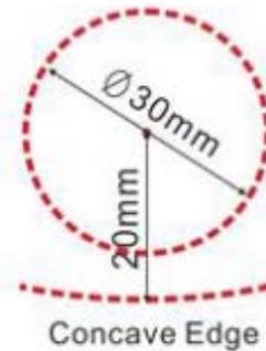
4. Bohren Sie die Kabeldurchführung.
