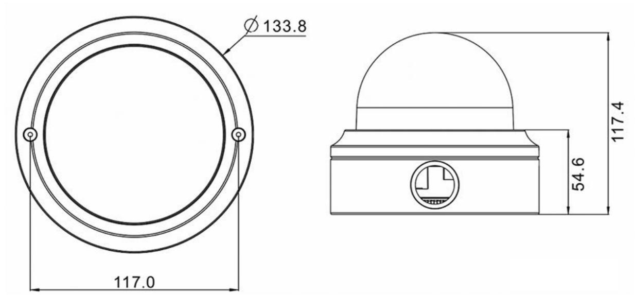
Fig. 1: Mx-VD2A-2-IR: Todas las medidas en mm
