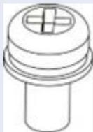
Tornillo 6-32 para caja de conexiones (x2)
