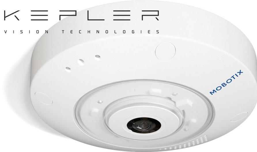
Capteur spatial intelligent à 360° pour la détection automatique des chutes :
