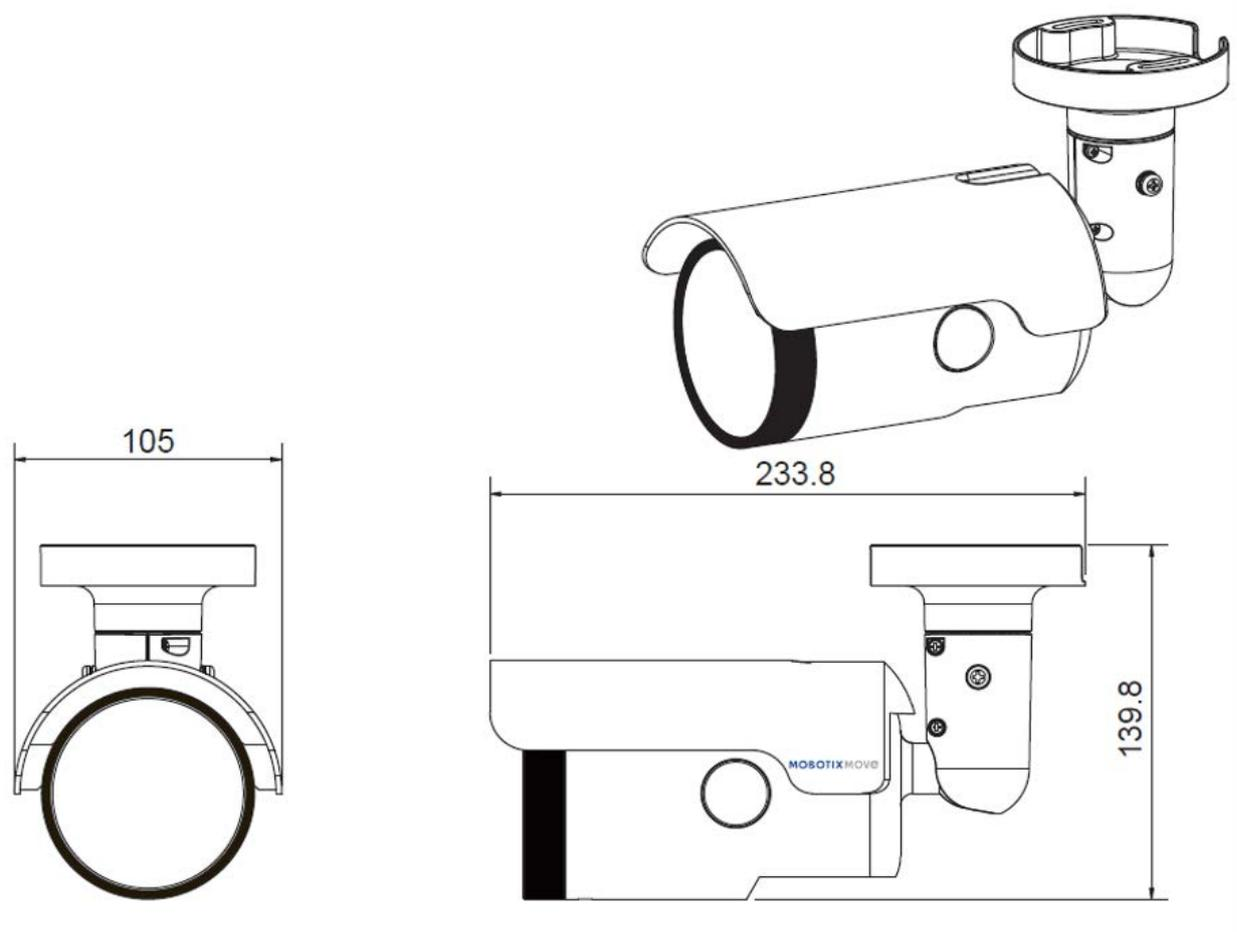
Fig. 1: Mx-VB1A-8-IR-VA: Todas las medidas en mm
