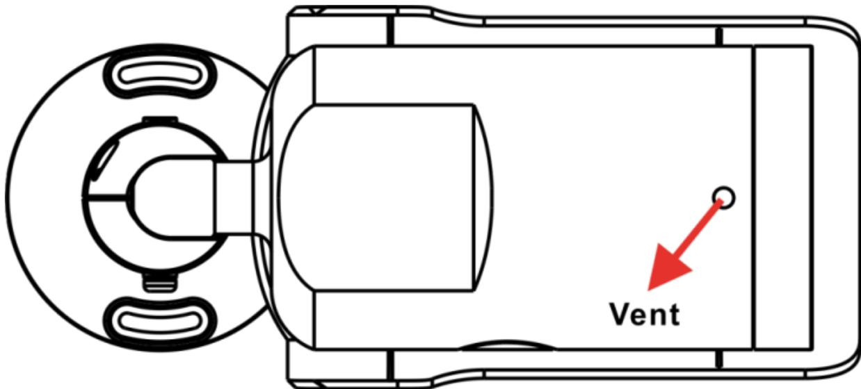
**VORSICHT!** Durch Entfernen der Trockenmittelpackung wird das Entlüftungssystem aktiviert und Feuchtigkeit kann in das Kameragehäuse eindringen, wenn die Kamera nicht sofort nach der Installation eingeschaltet wird!
