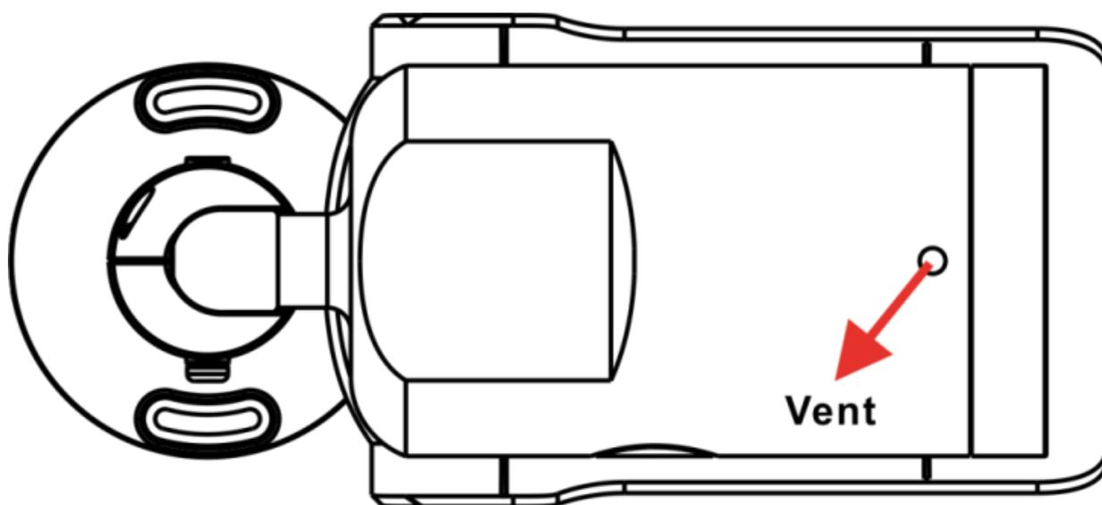
**ATENCIÓN!** Al retirar el paquete de desecante se activará el sistema de ventilación y podría entrar humedad en la carcasa de la cámara si esta no se enciende inmediatamente después de la instalación.
