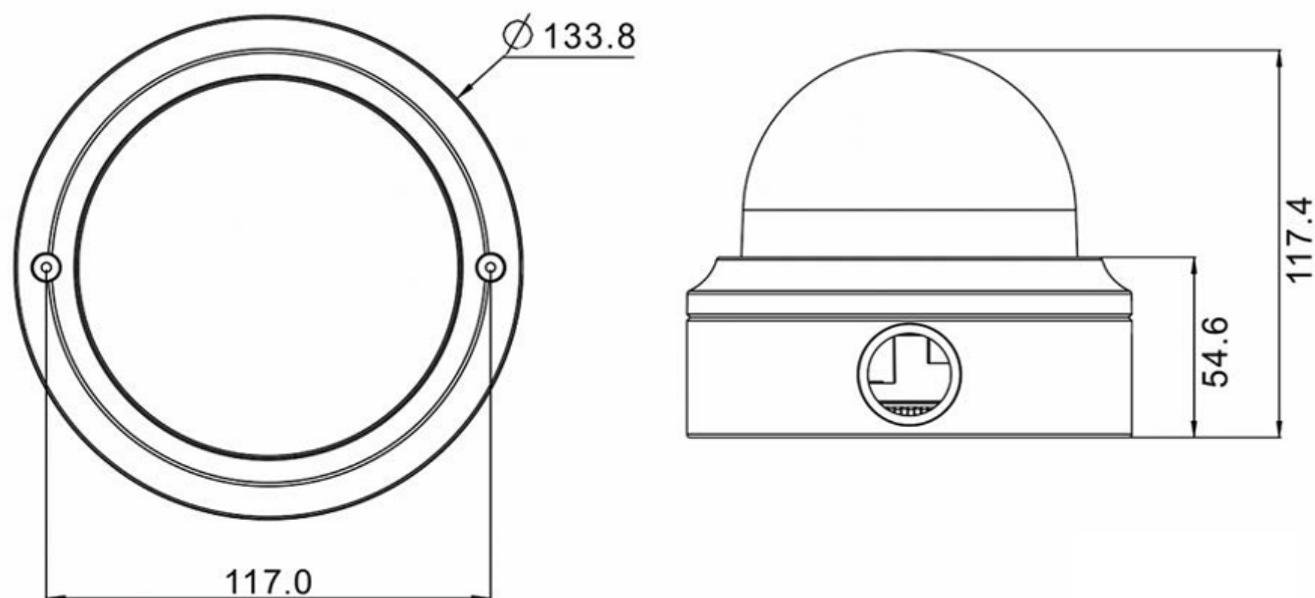
Fig. 1 : Mx-VD1A-8-IR-VA: Toutes les mesures sont en mm
