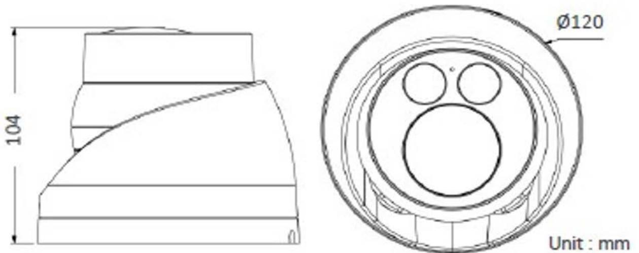
Fig. 1: Mx-VT1A-203-IR: Todas las medidas en mm
