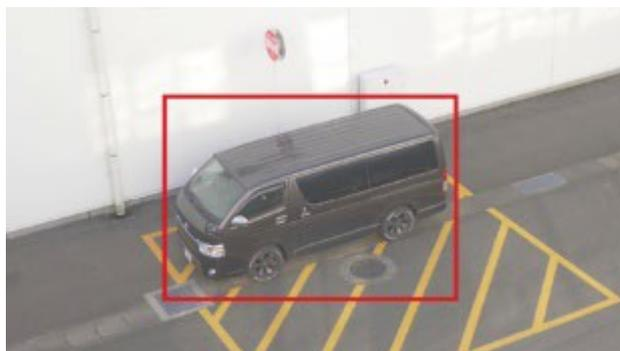
Une alarme se déclenche lorsque des corps en mouvement sont détectés dans la zone prédéterminée.
