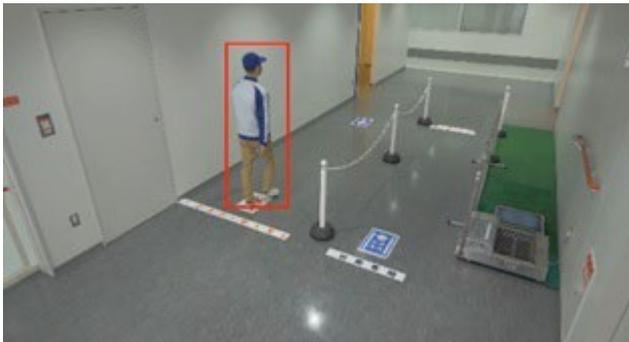
Une alarme se déclenche lorsque des corps en mouvement sont détectés en train de franchir la ligne prédéterminée dans la direction que vous avez indiquée.
