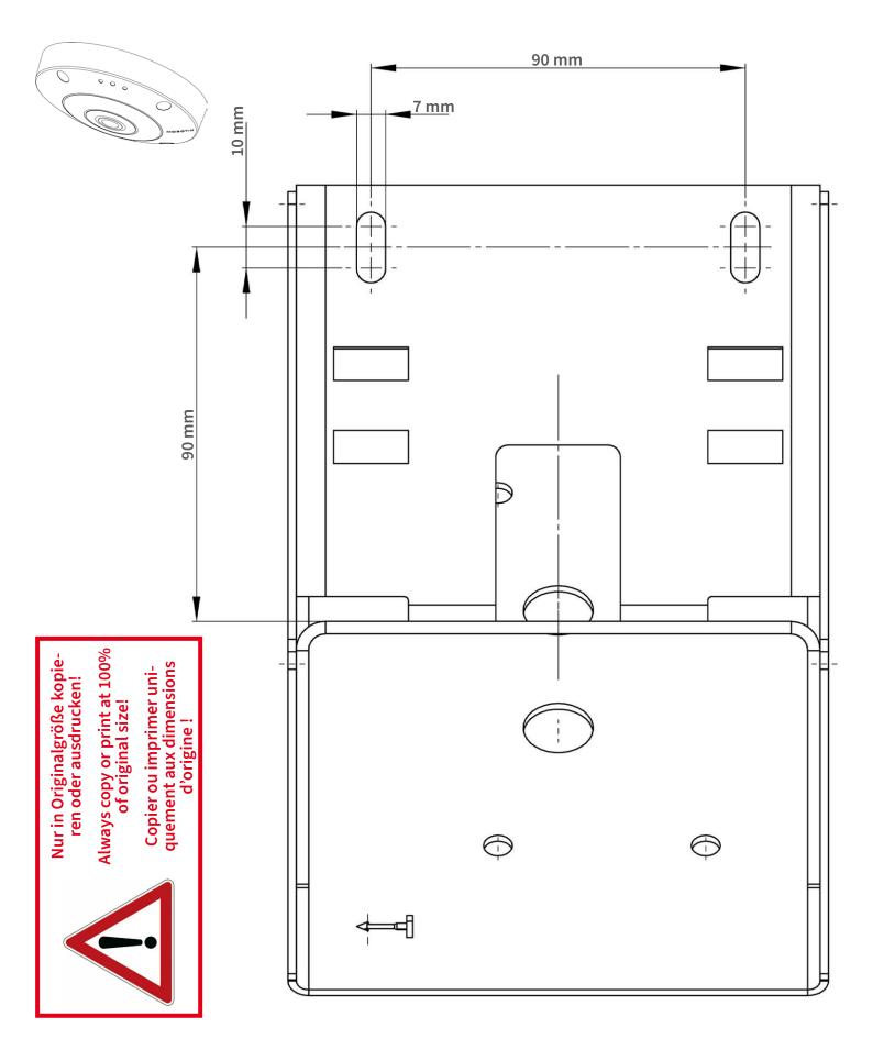
Bohrschablone / Drilling Template / Gabarit de perçage Maßstab 1:1 / Scale 1:1 / Echelle 1:1
