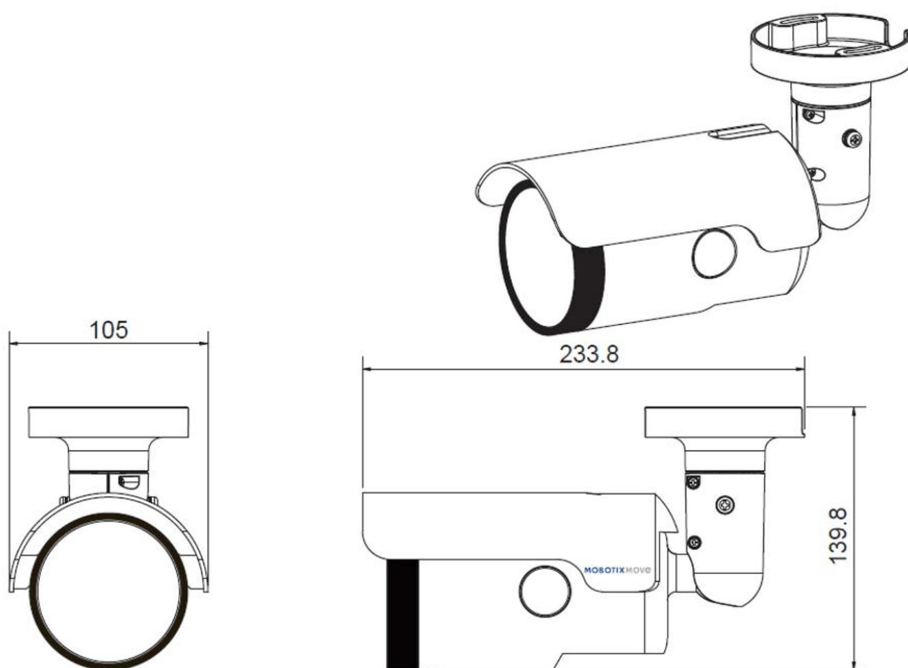
Fig. 1 : Mx-VB2A-5-IR-VA: Toutes les mesures sont en mm
